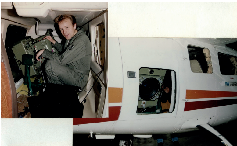
Vertikalkameraet RC 8 som skråfotokamera i Cessna 206. Truls Andersen tester utstyret. Foto: FWAS Internarkiv
