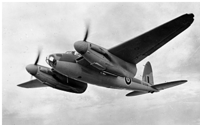
Tomotor Mosquito jagerbomber på vei mot Shellhuset. Vingerammer og skrog var bygget hovedsakelig av tre, noe som gjorde flyet ekstra sårbar med tanke på treff fra luftvern.
