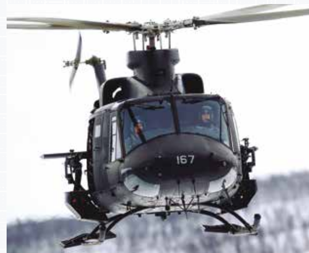
Et Bell 412 SP med Gatling mitraljøse påmontert på hver side av helikopteret. Foto Torbjørn Kjosvold.
