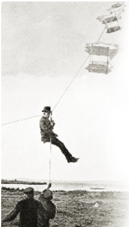
Roald Amundsen prøver den såkalte mannløftende dragen i 1909. Kanskje kunne dragen brukes til rekognosering i polarområdene? For å finne det ut satte Amundsen i gang forsøk i Horten. Resultatene tydet på at dragen kunne løfte et menneske flere hundre meter til værs. Men så en dag slo lynet ned i stålvaieren til dragen. En av karene til Amundsen mistet livet, og forsøkene ble stanset.
