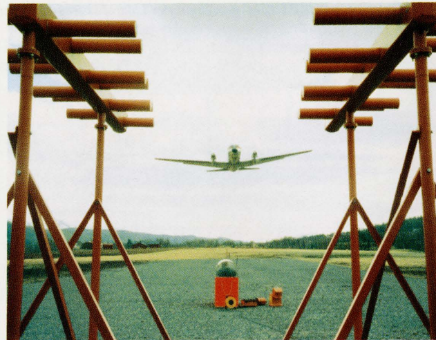
Luftfartsverkets kontrollfly kontrollerer retningsfyr. Legg merke til kontrolløren i den lille røde kassen foran antennene.
