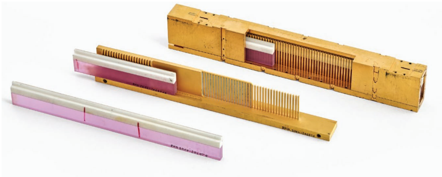
Figure 4.1 Deutsches Museum Collections Inv.Nr. 2014–2060: Travelling-wave maser. Photo: Deutsches Museum
