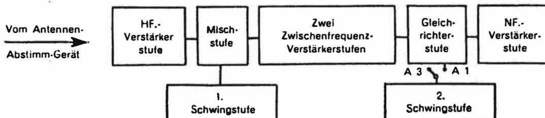
Der Kurzwellen-Empfänger E 10 K 1 kann nur an der Fest-Antenne betrieben werden. Für den Betrieb ist jedoch ein besonderes Antennen-Abstimm-Gerät erforderlich. (Siehe Abschnitt I D, Ziffer 97 und 102 bis 105.) Die Anschaltung des Empfängers an die Fest-Antenne erfolgt mit dem Wahlschalter am Fern-Bedien-Gerät FBG 3. Dieser Wahlschalter darf jedoch nur auf die Stellungen der Schaltgruppe Fest-Antenne geschaltet werden.
