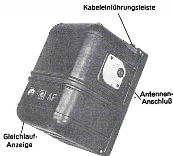
**Abb. 52: Antennen-Abstimm-Gerät AAG 2
