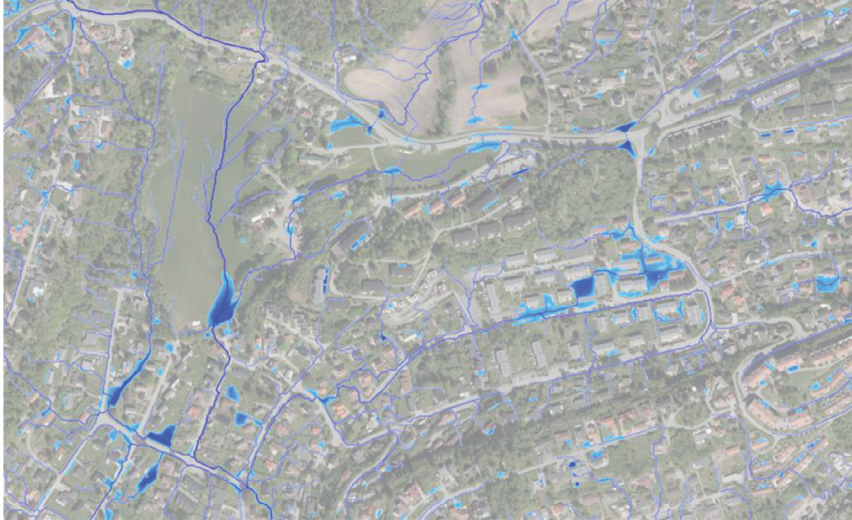
Figur 1. Eksempel på resultater fra terrengbasert analyse (SCALGO Live) for å indentifisere overvannsfare. Terskelen for at en avrenningslinje vises er at tilhørende nedbørfelt er minst 1000 m 2 . Terskel for at oversvømmelse vises er at vanddybden er minst 10 mm. (SCALGO, 2022) 42
